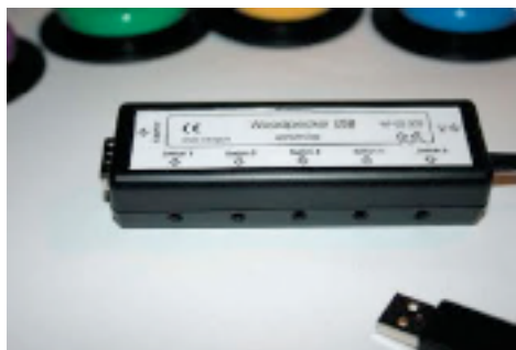
Commande de Kanghooru en mode défilement manuel, nécessitant une interface permettant de simuler les touches
