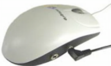
Commande de Kanghooru en mode défilement par un contacteur branché sur clic souris
